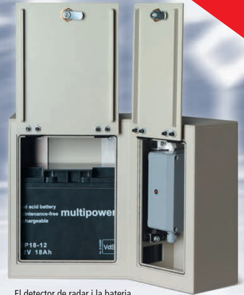
El detector de radar i la bateria estan darrere de les tapes frontals.
